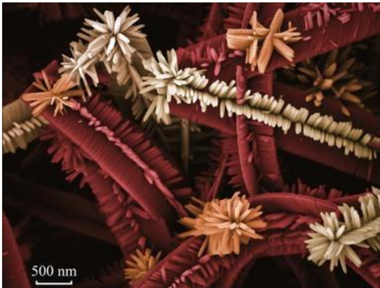
**Figura 10.** Imagen de las nanoheteroestructuras jerárquicas en forma de *nanocapillos* de SnO<sub>2</sub>, recubiertos de nanobarras de TiO<sub>2</sub>, capaces de una separación de carga eficiente y un transporte rápido de los electrones hacia el sustrato [17]
