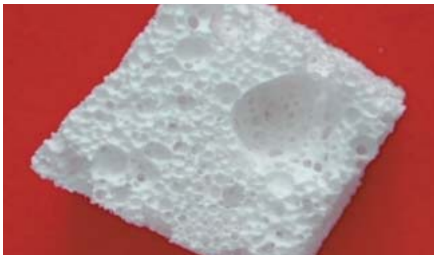
Figura 5. Material poroso de hidroxiapatita creado a partir del método de esponja polimérica.
