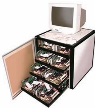
Figura 2. Wiglaf, construido a finales de 1994 en los laboratorios de la NASA; fue el primer sistema Beowulf de la historia, basado en dieciséis procesadores Intel 80486 de 66 MHz.
