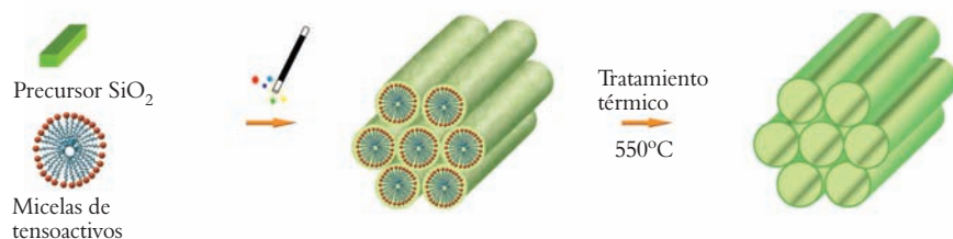
Figura 4. Síntesis de materiales mesoporosos
