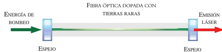
Figura 1. Representación esquemática de un sistema de fibra láser. El arreglo más simple está constituido por un par de espejos paralelos entre los que se coloca la fibra láser. La energía de excitación (bombeo) proviene de una fuente de luz láser externa.
