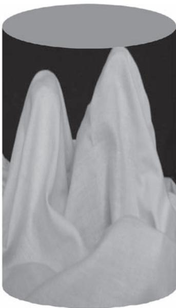
Figura 9. En el eje vertical se grafica la intensidad que vería un observador parado en el plano normal, sección transversal, a la dirección de desplazamiento del haz de electrones.
