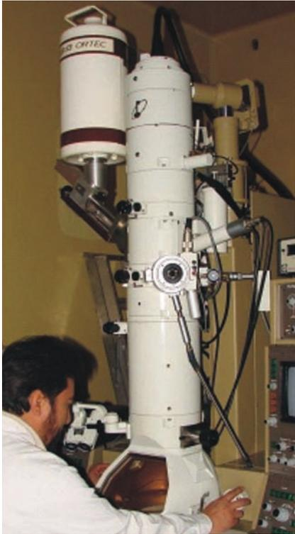
Figura 3. La columna principal del microscopio electrónico de transmisión.
