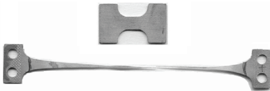
Figura 1. Aleación Zn-Al-Ag, deformada 800 % a 280 °C. Se muestra la probeta original y la deformada.
