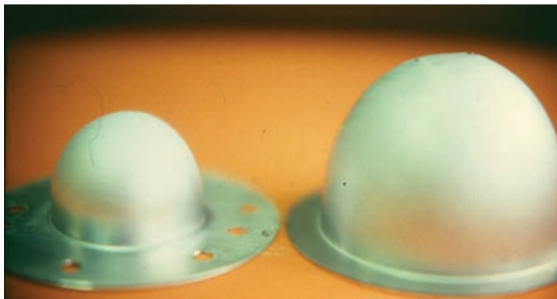
Figura 5. Domos obtenidos por el proceso de termoformado al vacío de lámina de zinalco.
