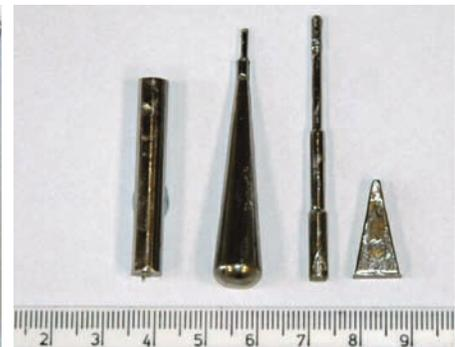
Figura 4. Fotografía de diversas muestras obtenidas por colada de succión.
