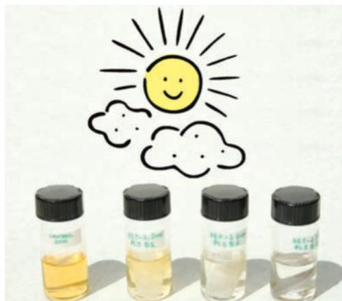
Figura 9. Degradación progresiva del colorante anaranjado de metilo usando películas de ZnO:Al y luz del sol.
