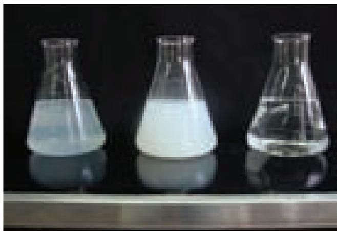
Figura 2. Agua gris tratada con cal. Los matraces, de izquierda a derecha, muestran las tres etapas de este tratamiento: agua gris, precipitado y agua resultante.
