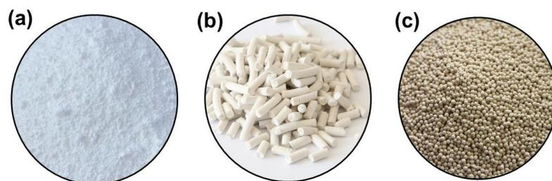
**Figura 1.** Catalizadores heterogéneos en diferentes etapas de escalamiento y forma. (a) polvo, (b) extruido cilíndrico y (c) extruido esférico.
