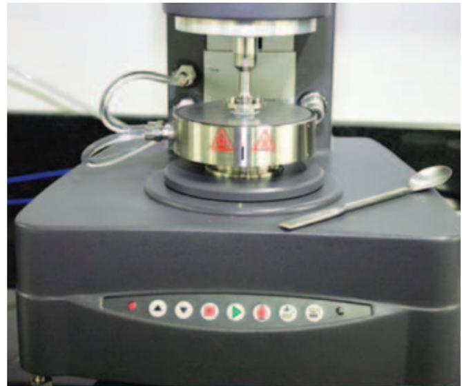
Figura 2. Reómetro TA AR-G2.
