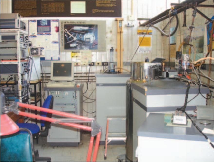
Figura 3. Vista de un laboratorio del departamento. Se aprecian un magnetómetro, un susceptómetro, diversos equipos electrónicos y los sistemas de cómputo para realizar las mediciones, almacenamiento y procesamiento de datos.
