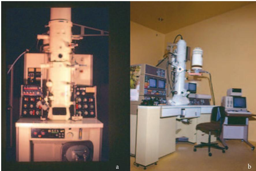
Figura 3. a) Microscopio electrónico de transmisión JEOL-200B, adquirido por el IIM en 1975. Fue el primer microscopio de alta tensión en América Latina. b) Microscopio JEOL 1200F, del tipo barrido-transmisión (STEM), equipado con espectrómetros EDS y EELS, así como con cámara de televisión.
