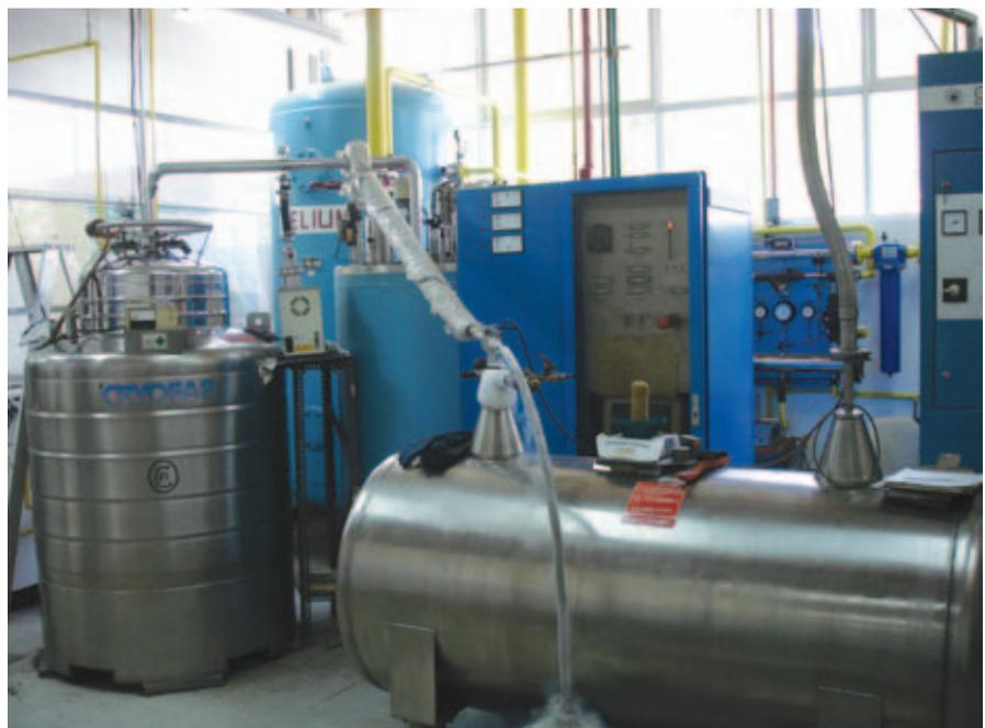
Figura 2. Licuefactor de helio líquido del IIM-UNAM. La ilustración muestra el Dewar para almacenamiento de helio, el sistema computarizado del licuefactor y un tanque de nitrógeno para enfriamiento del licuefactor.
