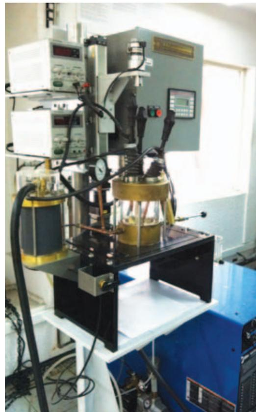
Figura 4. Horno de tres arcos y sistema de crecimiento de cristales.
