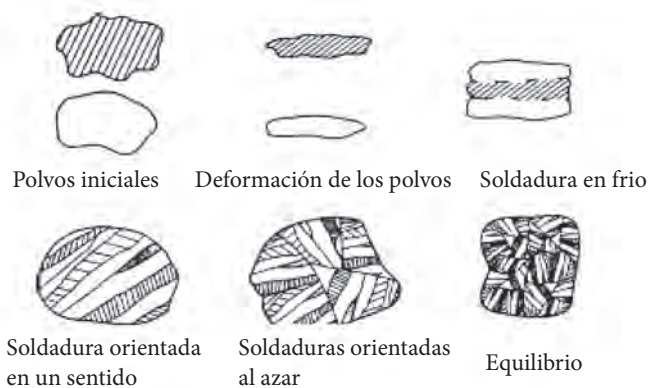
Figura 3. Esquema que muestra cómo los polvos son impactados por las esferas rígidas durante el proceso. 2
