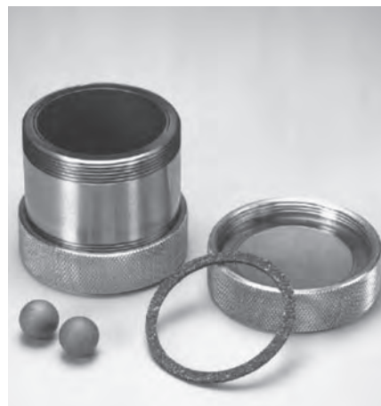
Figura 2. Recipiente y medio de molienda utilizado en el proceso de aleado y molienda mecánica. 2
