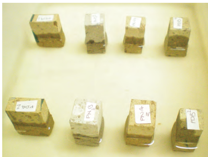
Figura 5. Evaluación de la porosidad y absorción de agua por capilaridad para rocas intervenidas con un nuevo material consolidante.
