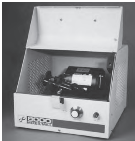
Figura 1. Molino tipo SPEX que se utiliza durante el aleado mecánico y la molienda mecánica. 2
