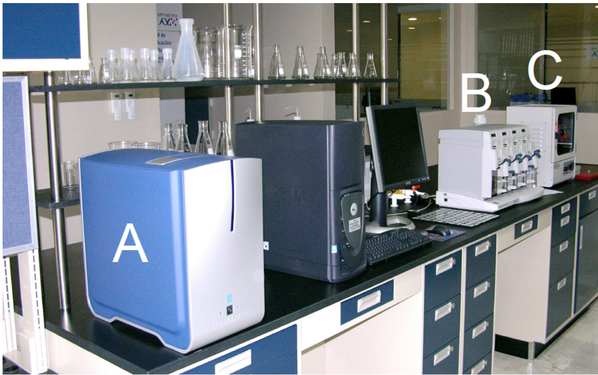
Figura 4. Montaje experimental para realizar análisis de expresión genética con gene chips. En la fotografía se ve una unidad de análisis de expresión montada con tecnología de Affymetrix®. En el panel A se muestra la unidad de lectura óptica o escáner, en el cuál se leen los chips de expresión genética una vez que las muestras se han hibridado en éstos después del termociclado y lavado en una unidad de microflujo. En el panel B se observa una unidad de microflujo con capacidad para lavar cuatro microchips simultáneamente. El panel C muestra un horno de hibridación para el termociclado de las muestras.
