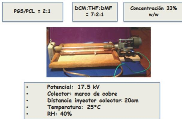
Figura 10. La mezcla PGS/PCL se disuelve en una solución de diclorometano, tetrahidrofurano y dimetilformamida para fabricar los andamios. El electrohilado se realiza en el colector del vástago giratorio, bajo los parámetros indicados arriba.
