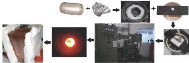
Fig. 4 Fabricación de las aleaciones Co-Cr en horno de inducción y solidificada en molde de cobre.
