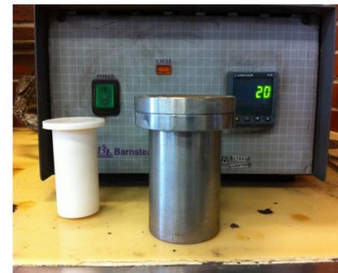
Fig. 1. Autoclave y horno utilizados para la síntesis hidrotermal.
