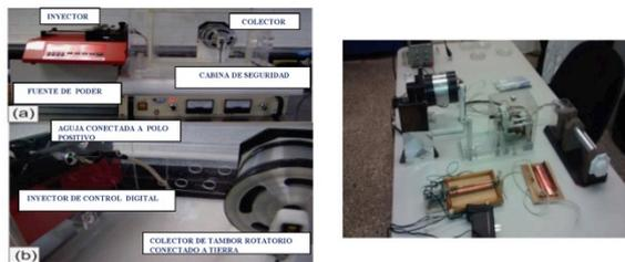
Figura 2. (A) Equipo de electrohilado en donde se resaltan sus componentes principales: Fuente de poder, inyector, colector, controladores y cabina de seguridad. (B) Colectores para elaborar diferentes tipos de andamios. (a) de tambor rotatorio, (b) plano, (c) rotatorio con desplazamiento para tubos de diámetro menor a 5 mm, (d) de tubos de diámetro mayor a 1 cm, (e) con curvatura y (f) tubular rotatorio. Vera R, Montiel R, Maciel A, et al (2013).
