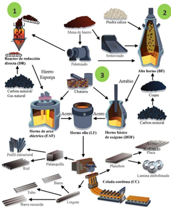
Figura 1. Esquema de las rutas de producción del acero. 1: Sub ruta DR-EAF. 2: Sub ruta BF-BOF. 3: Ruta directa. Imagen adaptada de [4]
