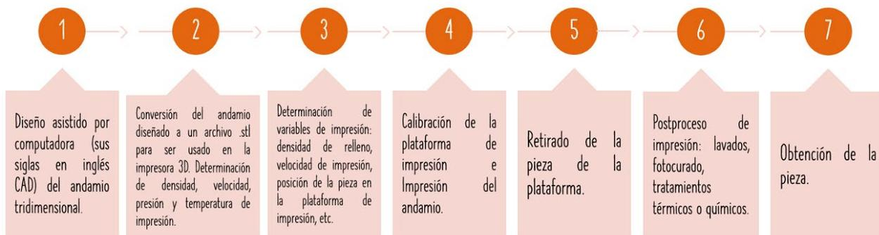
Figura 4. Diagrama de las etapas del proceso de impresión 3D.
