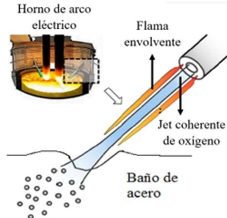
Figura 6. Esquema de la inyección de un jet coherente en un horno de arco eléctrico
