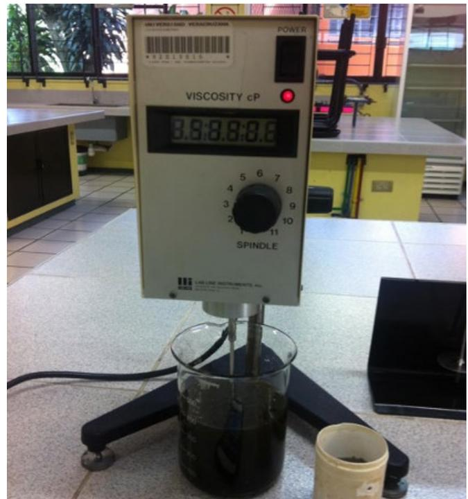
Figura 1. Viscosímetro Brookfield (modelo 4535)
