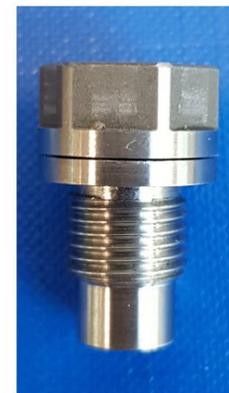
Figura 2. Ejemplos de miniceldas de punto fijo: (a) termómetro de 6 mm de diámetro exterior con minicelda de punto fijo integrada para su uso en temperaturas desde 300 °C hasta 650 °C [4], (b) celda con composición eutéctica Ru-C ( $T_f \approx 1954\text{ °C}$ ) acoplada directamente a un termómetro de vástago largo [5], (c) celda de Ga ( $T_f \approx 29.7\text{ °C}$ ) de 6 mm de diámetro exterior para su uso integrado en una instalación de calibración montada en un satélite [6].
