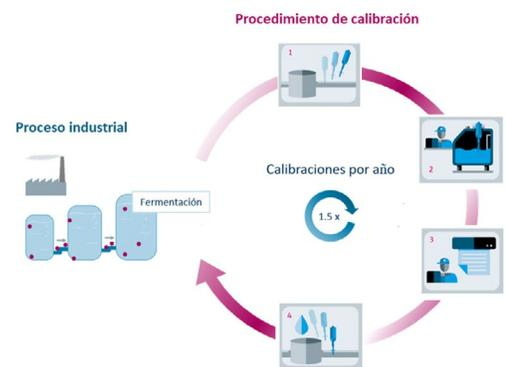
Figura 1. Esquema de un procedimiento de calibración típico de termómetros por fuera del proceso industrial. Los termómetros deben desmontarse de su instalación industrial y trasladarse a un laboratorio de calibración (1), donde se realiza la calibración (2), se documenta y certifica (3), antes de que el termómetro vuelva a instalarse en el proceso industrial (4).
