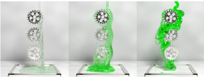
Figura 6. Tres engranajes interactuando con fluidos viscosos de diferentes valores de viscosidad, el modelo tiene en cuenta los efectos de arrastre, que pueden acelerar y desacelerar las velocidades angulares de los engranajes. Imagen tomada de (Takahashi, 2019)
