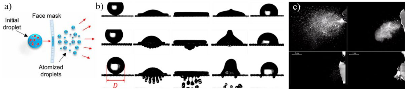
Figura 4. Ejemplos de gotas impactando textiles. a) Esquema del funcionamiento de una mascarilla (Imagen adaptada de la referencia 12). b) Gota impactando textiles, sin penetración (arriba), penetrando parcialmente (en medio) y totalmente (abajo). c) Disminución de la expulsión de gotas al estornudar mediante el uso de mascarillas (Imagen adaptada de https://www.dailymail.co.uk/news/article-8553491/Video-reveals-homemade-masks-TWO-layers-fabric.html ).
