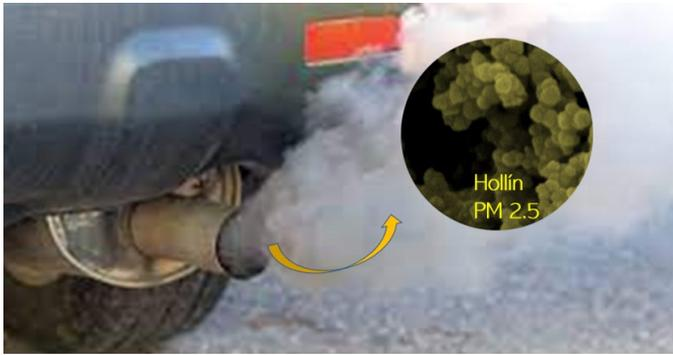
Figura 1. Esquemática de la emisión de partículas de hollín. En el inserto de la imagen se muestran las partículas individuales que conforman los aglomerados de hollín.
