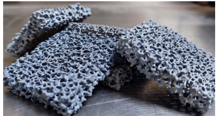
Figura 5. Espumas cerámicas fabricadas con carburo de silicio y usadas como medios de filtración de metales fundidos
