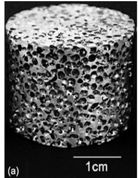
Figura 1 (a). Espuma metálica de aluminio
