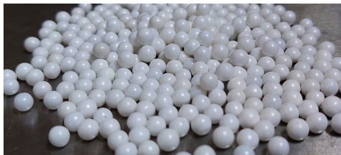
Figura 3. Esferas de zirconia estabilizada con itrio usadas como medio de molienda
