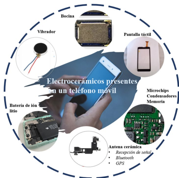
Figura 4. Presencia de los materiales cerámicos en los componentes de un teléfono móvil moderno
