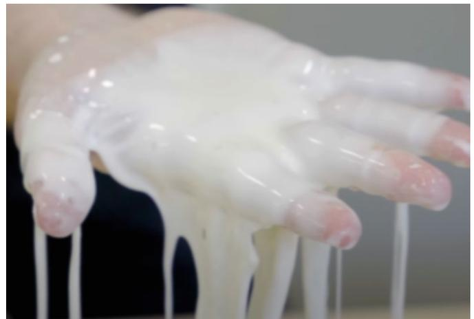
Figura 3. Suspensión de almidón de maíz en agua donde: (arriba) al ser deformada tiene un comportamiento tipo sólido, y (abajo) al cesar la deformación tiene un comportamiento tipo líquido. Open Access from Massachusetts Institute of Technology (MIT) (October 5, 2019) The science of cornstarch and water [video captures] Youtube. <https://youtu.be/mYTerCbDUzE?si=43E0Als7IzjooxCW> by Creative Commons CC BY license.
